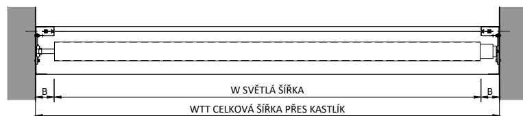
PŮDORYS - UPEVNĚNÍ DO OTVORU
